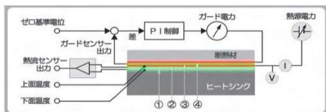
そのときの熱流センサーの出力電圧と供給電力との比から正確な「感度定数」が検定されます。
