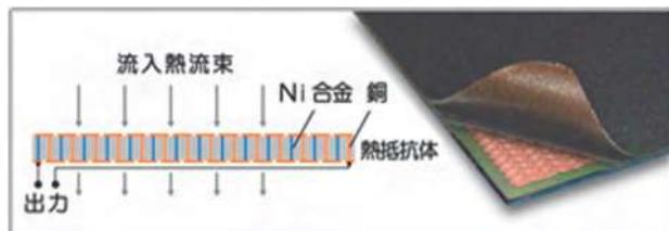
両面に構成された熱電対のペアは熱流板全面に均等に、且つ
