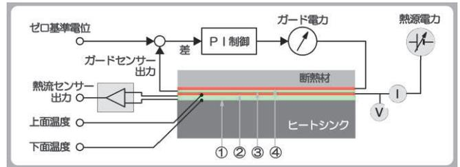
そのときの熱流センサーの出力電圧と供給電力との比から正確な「感度定数」が検定されます。
